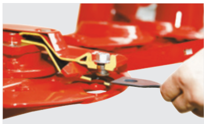
FAST-FIT系统的刀片更换速度非常快
