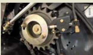
标准的链条自动润滑系统，允许单独调整各个链条的润滑油用量
