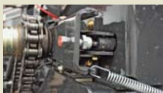
从拖拉机驾驶室可以操作标配的液压转子离合器
