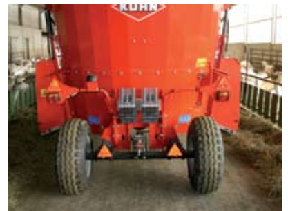
左侧和右侧卸料滑槽
