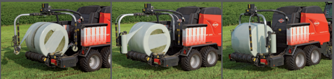
“剪刀型”薄膜切断器可靠、整齐地完成薄膜切割
