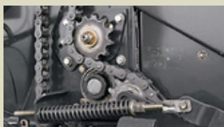
简洁的传动系统，带1¼重载链条，采用了特殊设计，适于最苛刻的工作环境，维护工作量最小
