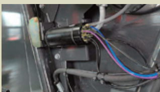
可选的链条自动润滑系统。该系统可以单独地调整各个链条的润滑油用量
