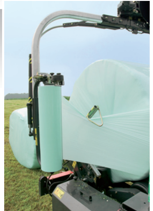
“剪刀型”薄膜切断器可靠、整齐地完成薄膜切割
