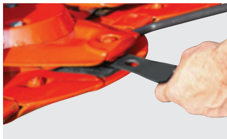
FAST-FIT附件：可以快速更换刀片。
