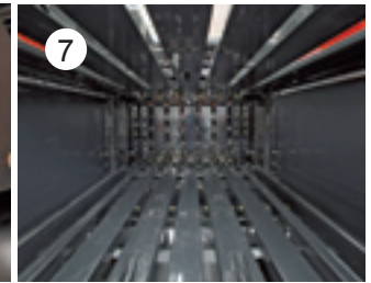
3米（10"）长的打捆室，带末端推出功能
