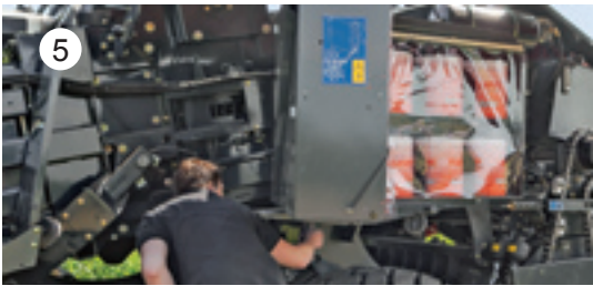
方便进行机器维修的铰链式线绳存放箱
